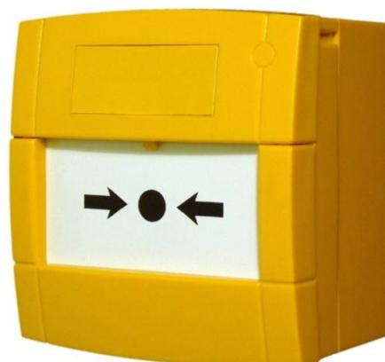
Les boutons poussoirs colorés MCP4A sont très pratiques à installer grâce aux connecteurs coulissants. Les boutons poussoirs ont un contact inverseur bipolaire normalement ouvert ou fermé. Les déclencheurs manuels sont munis d'une vitre flexible incassable, qui est réinitialisée avec la clé de test. Le bouton poussoir a une fonction anti-sabotage : dès que la vitre ou la face du bouton poussoir est enlevée, le bouton passe en état d'alarme.
