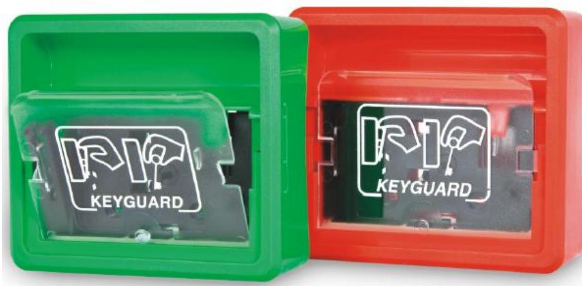
Les boîtiers protège-clés Keyguard sont destinés à protéger une clé ou une carte d'accès. En cas d'urgence la vitre est brisée pour atteindre la clé (carte). Il est impossible de remettre la vitre après usage. Etant en plastique, la vitre brisée n'occasionne ni éclats ni bords coupants. Le boîtier peut être muni d'une alarme: un ronfleur qui fonctionne sur pile ou un contact inverseur pouvant être connecté à un système d'alarme.
