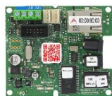
Montage à l'intérieur du boîtier • Prend en charge les protocoles SIA, Contact ID et Microtech pour la transmission d'alarme • Prise en charge de l'inspection de routine à distance (RRI) via le flux RSS. • Transmission des alarmes et de l'assistance à distance pour les systèmes GalaXy FLEX via le protocole TCP/IP. • Conforme à EN50131-3: 2009, EN50131-6: 2008, PD6662: 2010, Classe de sécurité 3, Classe environnementale II, Classe ATS 4
